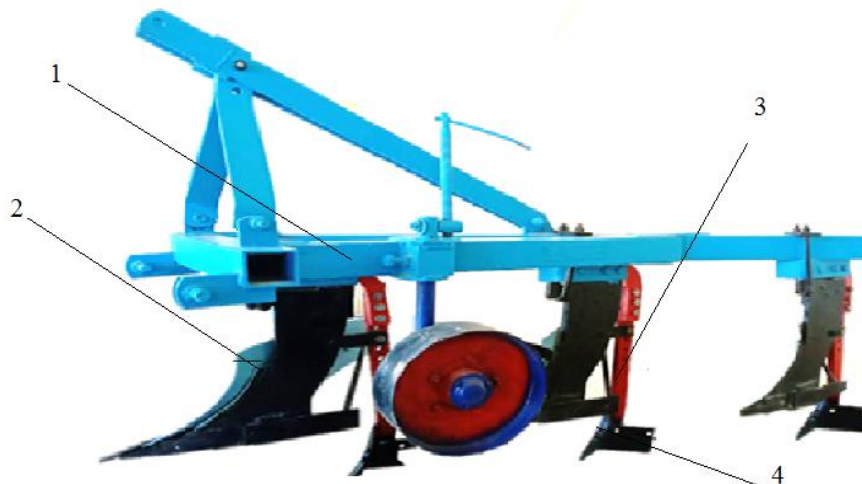
2-расм. Такмиллашган чуқурюмшаткичли плуг
